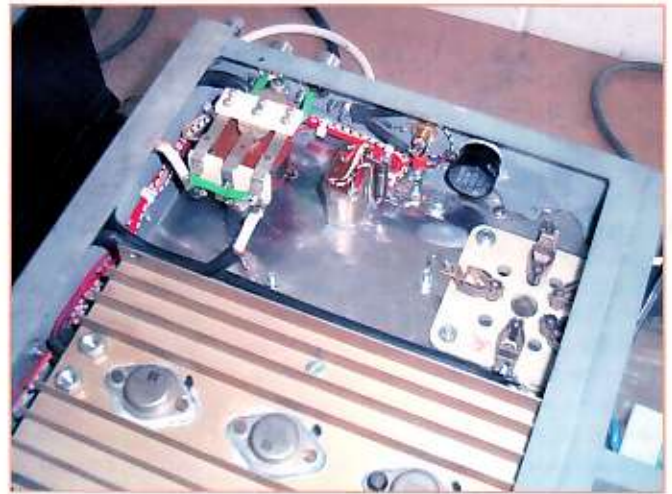
Foto 5: een manier om de relais en de transistor voor het schakelen ervan te monteren
